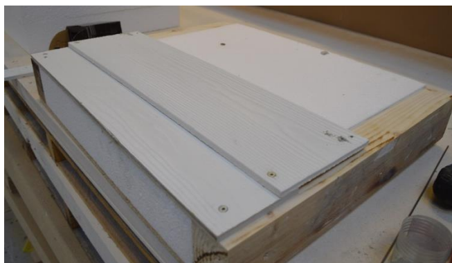
Prøveemne med klinkbeklædning af fibercementplanker
